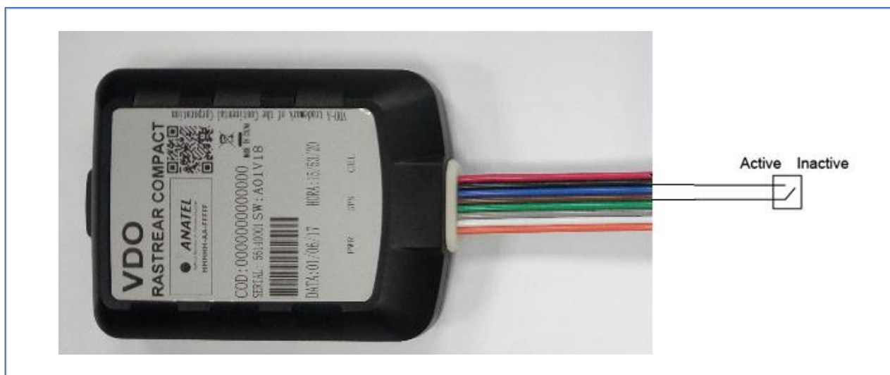
Figura 4. Exemplo de Conexão da Entrada Digital ao Negativo (-)
